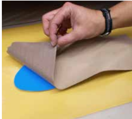
Oberdeckenmaterial auflegen und aufbügeln.
